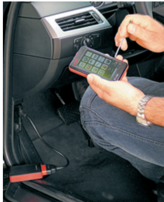
Dopasowanie elementów wymaga zastosowania odpowiedniego przyrządu diagnostycznego.
