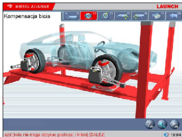
Wizualizacja czynności pomiarowych urządzenia do geometrii kół
