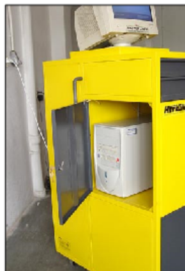
Jednostka centralna komputerowego urządzenia do pomiaru geometrii nadwozia
