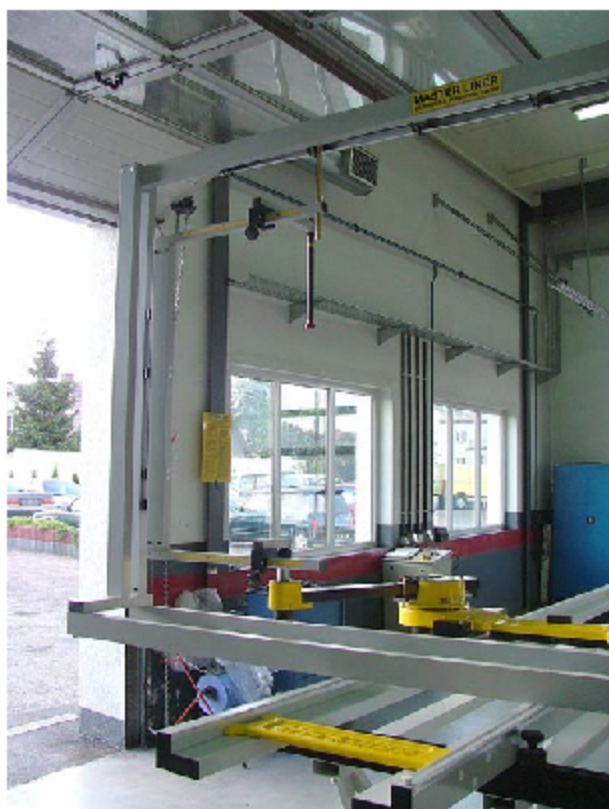
Mechaniczno- elektroniczne urządzenie do kontroli geometrii nadwozi
