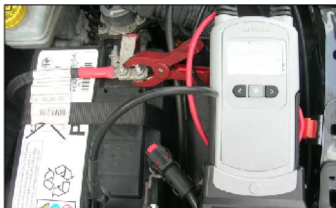
Do diagnozowania stanu technicznego akumulatora przydatny jest odpowiedni tester
